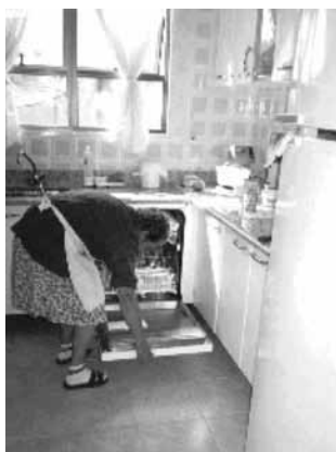
Figuras 6 e 7 – Posturas incorretas adotadas pela usuária, decorrentes da medida antropométrica da máquina lava-louças, que está em uma altura inadequada; a altura do porta-papel também está inadequada; a altura do armário superior poderia ser um pouco menor. Isso exige que a usuária curve ou torça a coluna e fique na ponta dos pés. (Fonte: Dados da Pesquisa)
